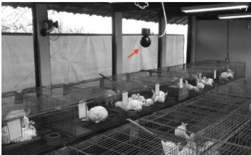
Figura 5. Novo dispositivo para medição da temperatura de globo negro em instalação de cunicultura
