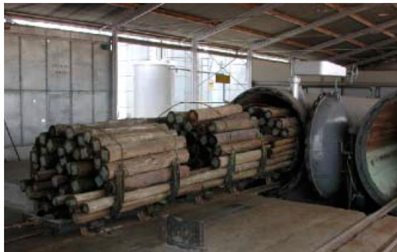
Figura 1 – Modelo de recipientes cilíndricos de aço (Autoclave) usado no tratamento CCA.
