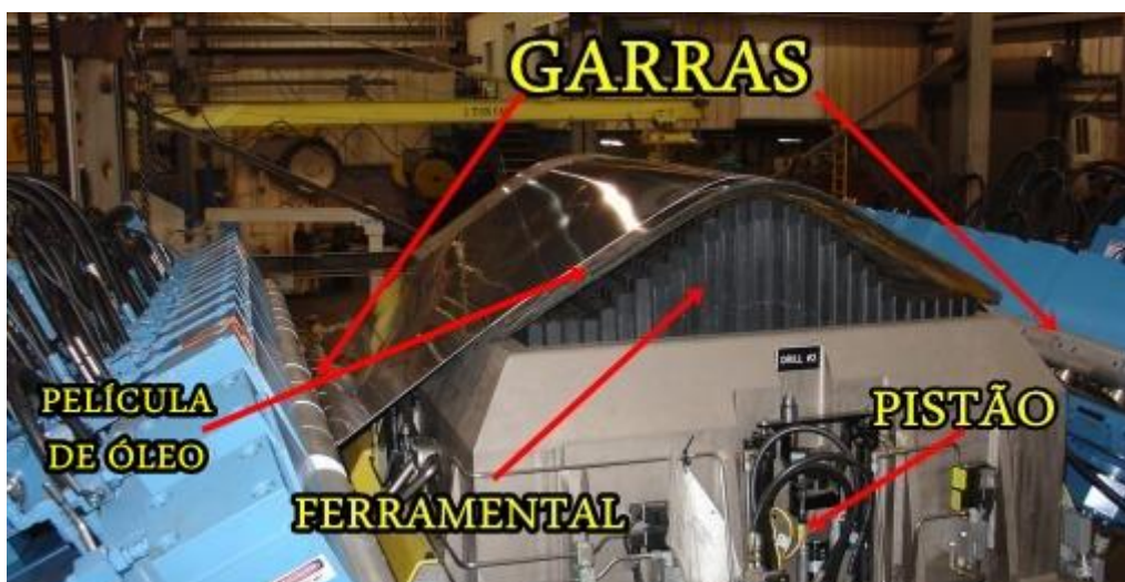
Figura 1 Estiradeira Cyril Batch em processo de estiramento e seus componentes
